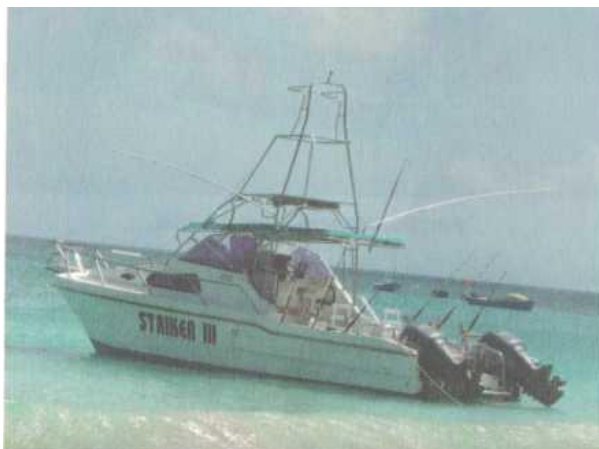
Рис. 88. Применение подвесных моторов на судне с вышкой тауэром. Сейшельские острова, остров Маэ, Бо-Валон.
