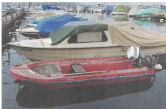
Рис. 90. Рабочая шлюпка из полиэтилена. Женева, Швейцария.
