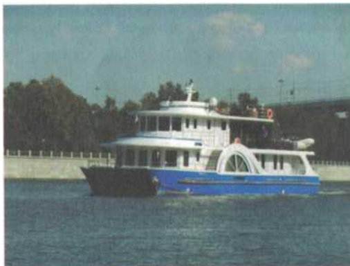
Рис. 32. Катамаран «Забава». В декоре судна используются «фальшивые» кожуха гребных колёс.
