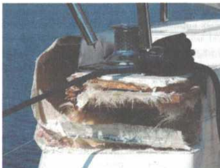
Рис. 7. Повреждение стеклопластикового корпуса в результате столкновения.
