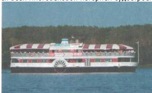
Рис.33. Прогулочное судно с "фальшивыми гребными колёсами".
