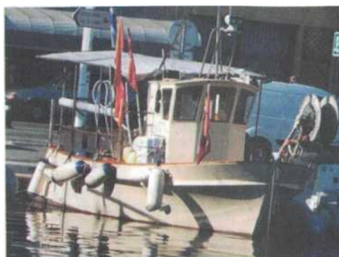
Рис. 58. Пассажирский паром с электродвижением от солнечных батарей. Женева. Швейцария
