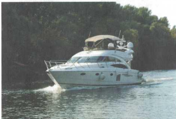
Рис. 4. Моторная яхта со «снарядообразной» формой носа.
